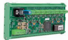
Dräger REGARD 8-channel display
